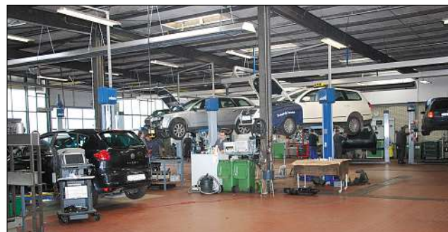
Hebebühnen wurden versetzt und schräg angeordnet, um keine Arbeitsplätze in der Werkstatt einbüßen zu müssen. Eine neue Deckenstrahlheizung sorgt für eine angenehme Arbeitsatmosphäre.
