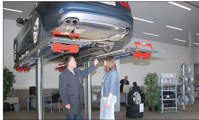
Zurzeit verfügt die neue Dialogannahme über zwei Hebebühnen. Eine dritte Zweistempelbühne will der Bauherr demnächst installieren. Die baulichen Voraussetzungen dafür sind bereits vorhanden.
